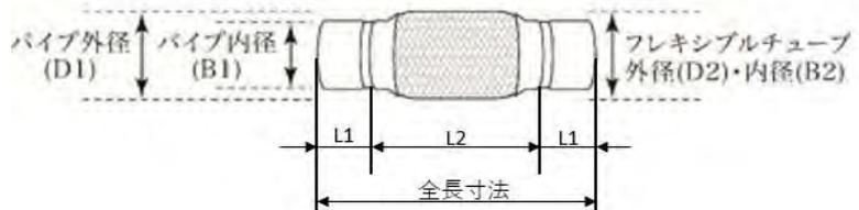
**両端パイプ:鉄製 フレキシブルチューブ:ステンレス製**
