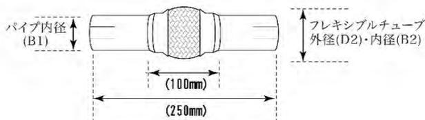
**両端パイプ:鉄製 フレキシブルチューブ:ステンレス製**
