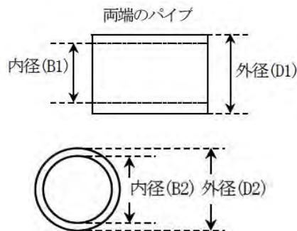
**両端パイプ:鉄製 フレキシブルチューブ:ステンレス製**
