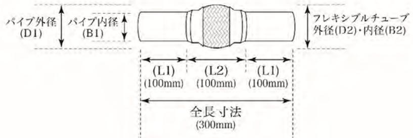
**両端パイプ:鉄製 フレキシブルチューブ:ステンレス製**
