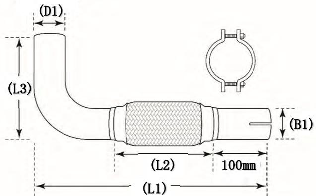
**両端パイプ:鉄製 フレキシブルチューブ:ステンレス製**
