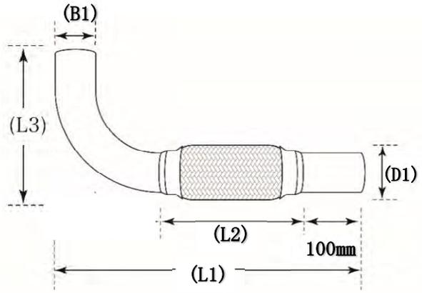
**両端パイプ:鉄製 フレキシブルチューブ:ステンレス製**
