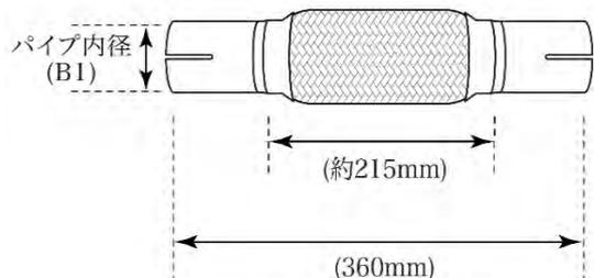
両端パイプ:鉄製 フレキシブルチューブ:ステンレス製
