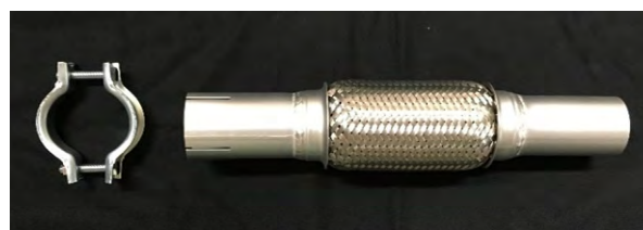
ベローズタイプ(1重ブレード巻き)Bタイプ パイプ付き(フレキ全長は215mm) 74系 P72
